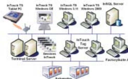
Exemple d'architecture en Terminal Services
